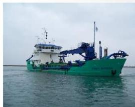
La Cap d'Aunis appartient au Grand port Maritime. Elle dispose d'un bras articulé sur le coté ou élinde qui, plongé au fond des zones à draguer aspire les sédiments avec de l'eau de mer. Ceux ci sont renvoyés dans une cuve de stockage. Les sédiments, plus lourds, se déposent au fond de cette cuve et l'eau de mer est éliminée par surverse. Cette drague se déplace ensuite vers une zone d'immersion et clape les vases en s'ouvrant en deux (dragage fendable)
