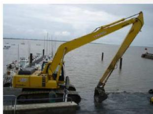
Les sédiments ainsi recueillis sont versés dans des camions à benne étanche avant d'être stockés puis déshydratés en vue d'une réutilisation en épandage ou pour conforter les digues.
