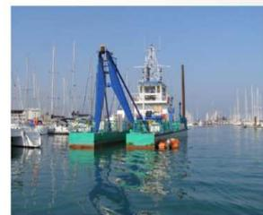
Elle dispose d'un bras ou cutter qui plongé sous l'eau est orienté de haut en bas et de droite à gauche. Ce cutter muni d'une fraise désagrège la vase, celle-ci est aspirée et mélangé avec de l'eau de mer par une pompe puis refoulée dans une canalisation flottante.
